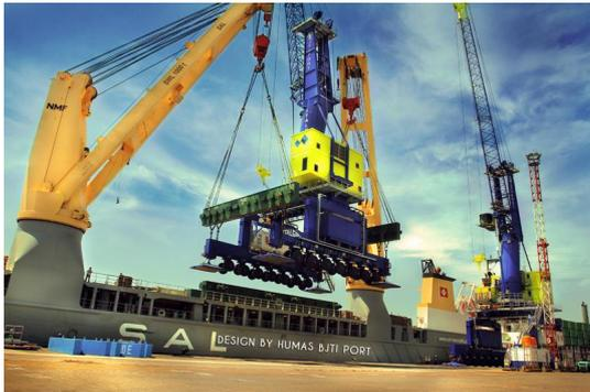
Bertepatan dengan Hari kemerdekaan RI Selasa (17/8) Terminal Berlian kedatangan alat berupa 2 (dua) unit Harbour Portal Crane (HPC) asal Italia. Kelebihan HPC tersebut bisa mengangkat kapasitas hingga 120 ton. Berbeda dengan HMC, pada HPC terdapat perbedaan konstruksi yang membuat truk bisa lalu lalang dibawahnya, sehingga pengaturan lalu lintas di Terminal Berlian lebih efisien karena tidak mengganggu arus lalu lintas truk yang sedang mengangkut barang.
